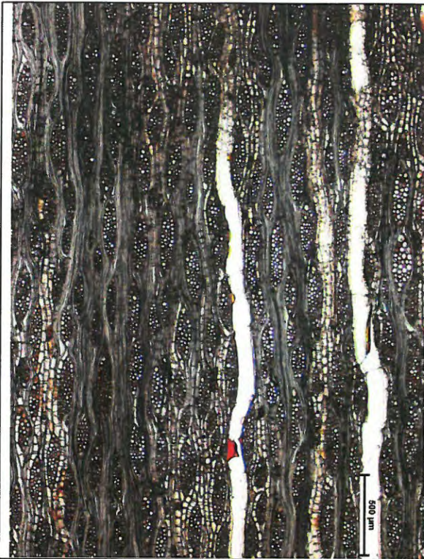
Foto 6: T; HS unregelmäßig und stellenweise mit Stockwerkbau; M 40:1
