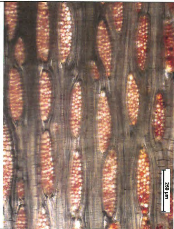
Foto 8: T; Bereich mit stockwerkartiger HS-Anordnung; M 100:1
